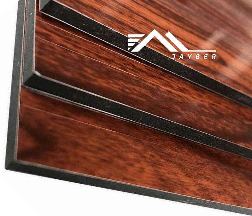
**ACP**, o Aluminium Composite Panel, son paneles decorativos compuestos de PVDF/PE (PolyVinylidene Fluoride), aluminio anticorrosivo, adhesivo, LDPE (Low Density Poly Ethylene), más adhesivo y terminado con aluminio anticorrosivo.
